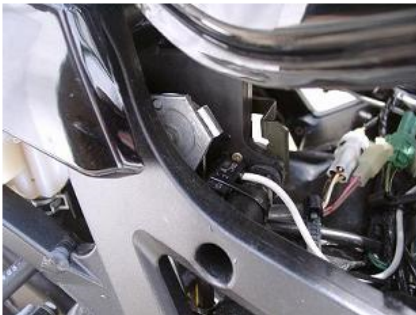
Bild 1: Auspuffklappenstellscheibe K3/K4 von rechts gesehen (habe leichte Zweifel an der Richtigkeit des Bildes, kann jemand helfen?)
