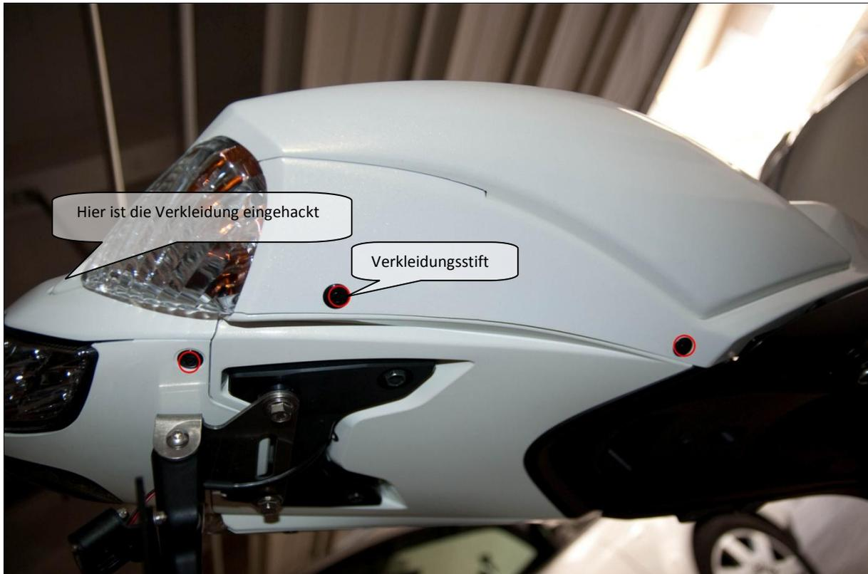
Nachdem die Verkleidungsschrauben / Stecker weg sind, kann man ganz einfach die Seitenverkleidung herausnehmen. Zuerst die Verkleidung vorne beim Sitz aus der Verkleidung lösen und dann seitlich wegziehen.
